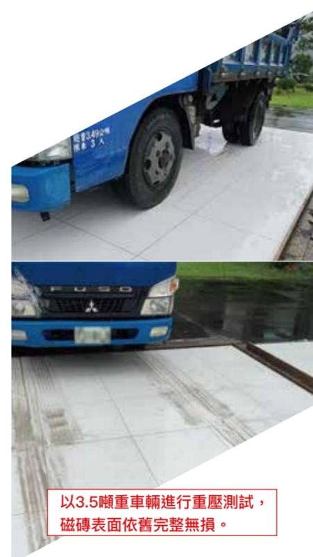
以3.5噸重車輛進行重壓測試，磁磚表面依舊完整無損。
